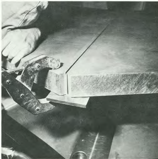
Préparation des secteurs d'aluminium de 60 mm d'épaisseur et de 900 mm de large pour la soudure par bombardement.
